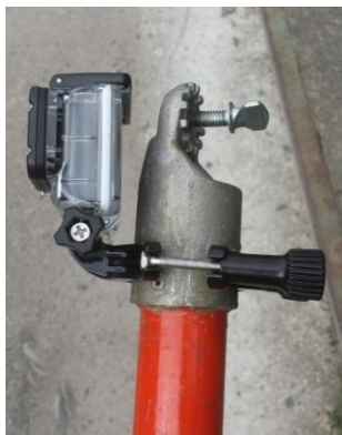
Montasje av kamera på isolerstang.
