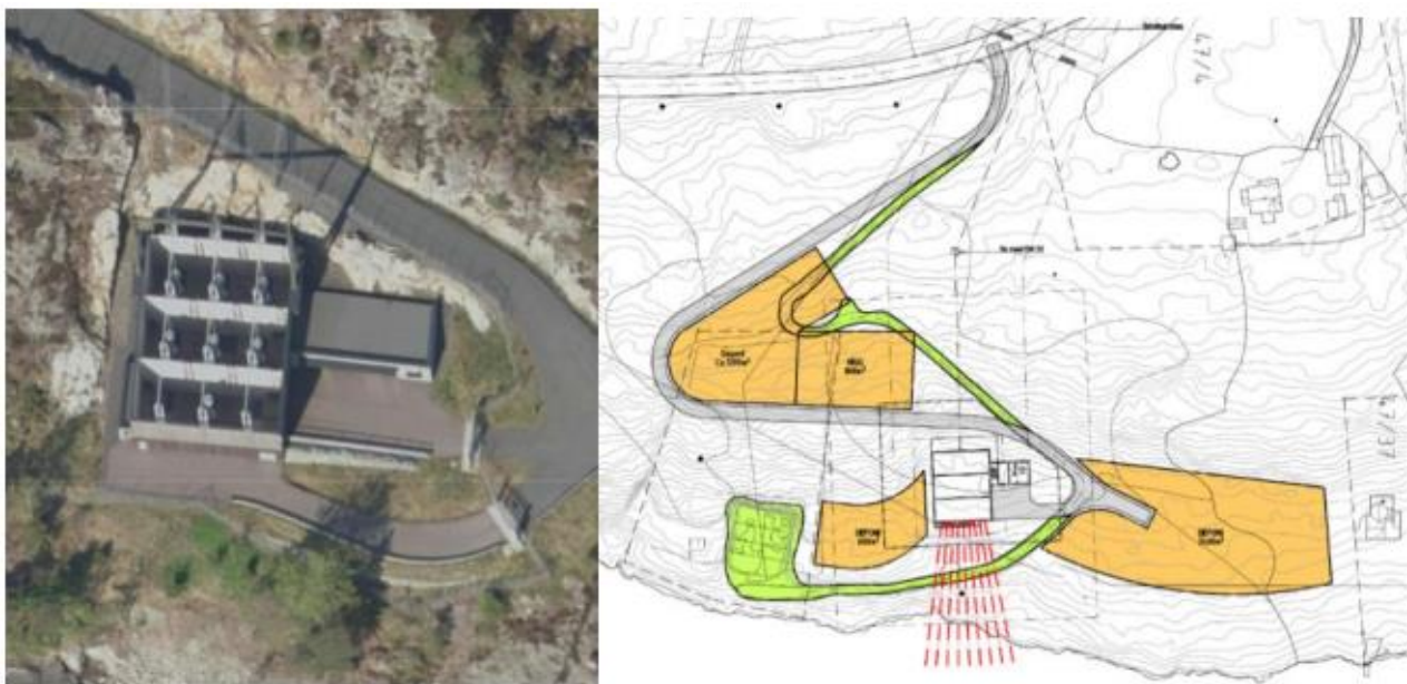
Figur 2-5. Eksempel på muffestasjon fra Indre Oslofjord.
