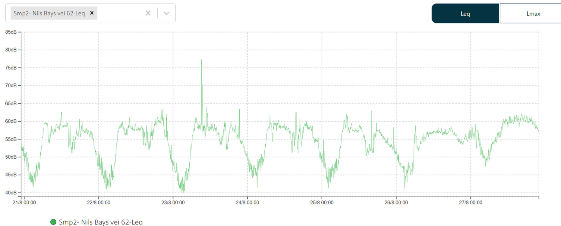
Figur 7 Støymålinger fra målestasjonen Nils Bays vei 62 for perioden 21. august til og med 27. august. Kurven viser femminuttersverdier for støy gjennom hele måleperioden.
