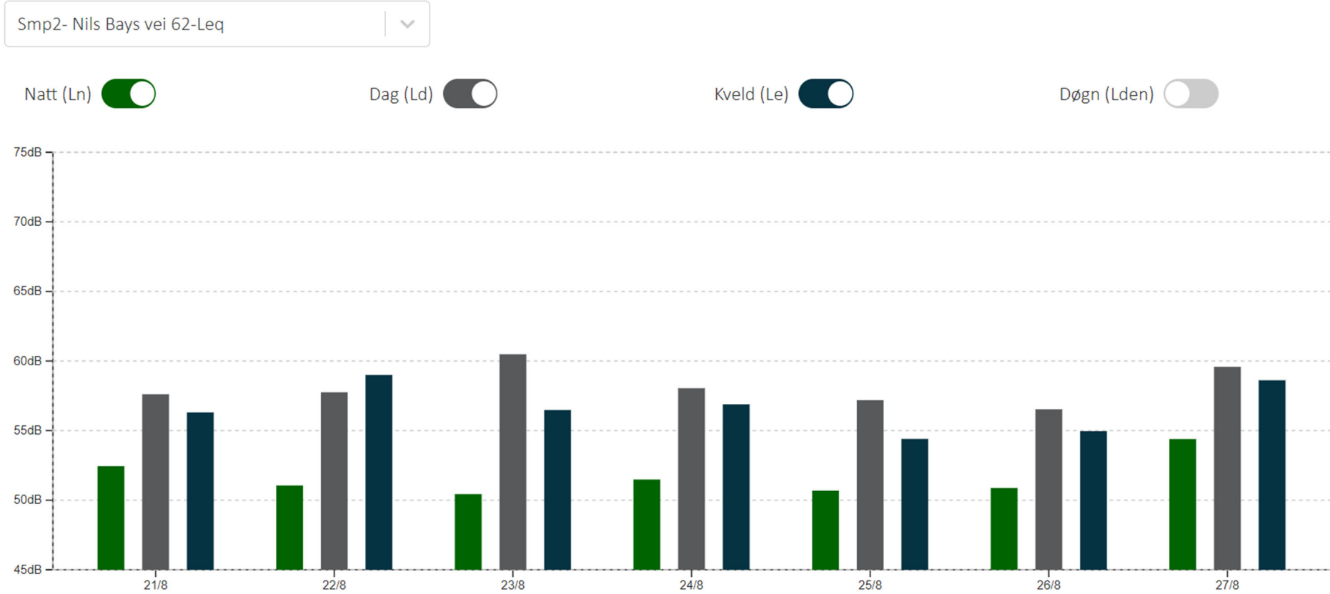
Figur 6 Resultater fra målestasjon Nils Bays vei 62 for perioden 21. august til og med 27. august. Stolpene viser gjennomsnittsverdier for dag (7-19), kveld (19-23) og natt (23-07).
