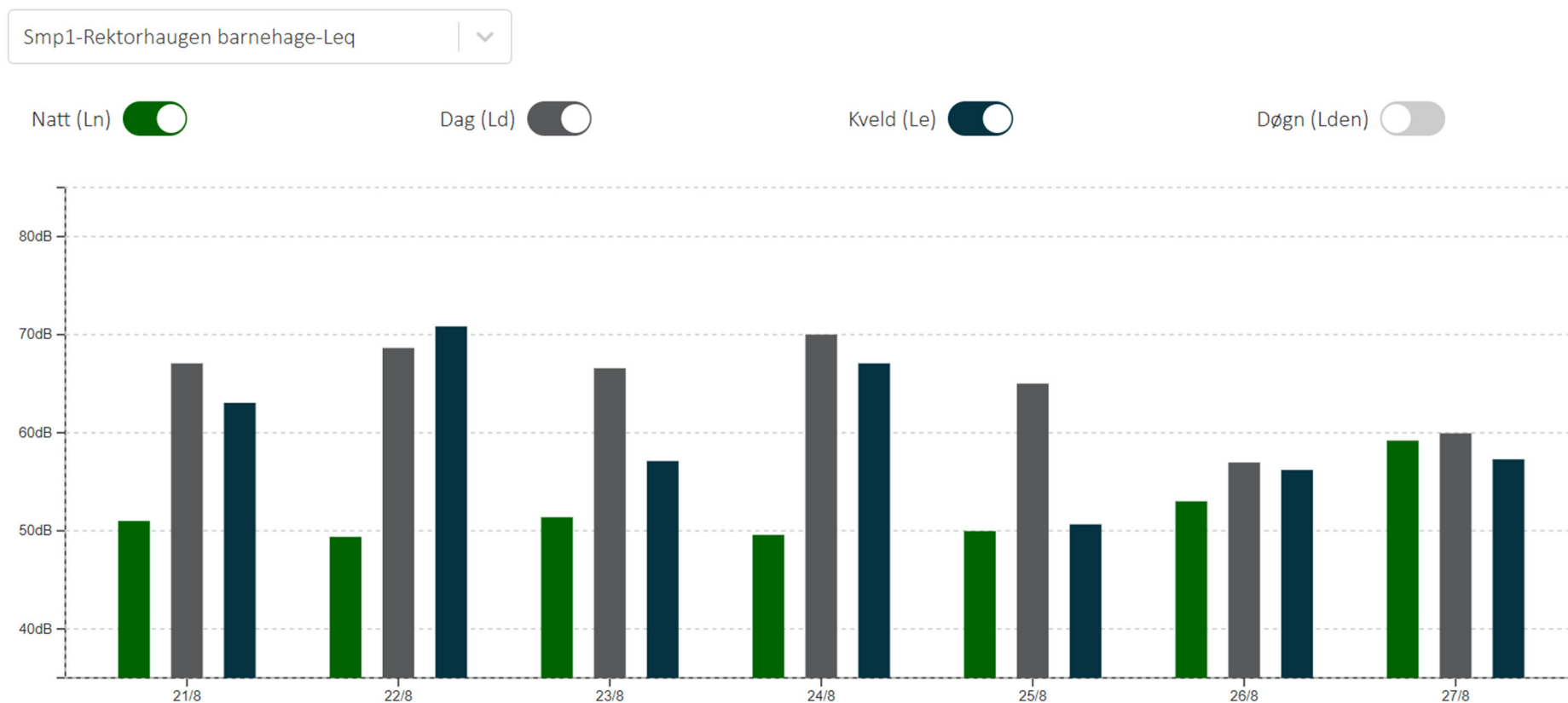
Figur 3 Resultater fra målestasjon Rektorhaugen barnehage over støyskjermen for perioden 21. august til og med 27. august. Stolpene viser gjennomsnittsverdier for dag (7-19), kveld (19-23) og natt (23-07).
