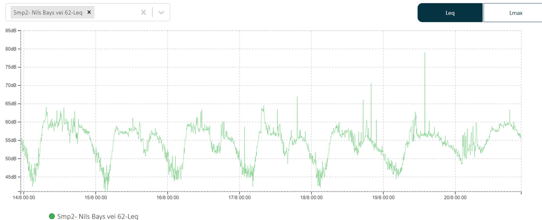
Figur 7 Støymålinger fra målestasjonen Nils Bays vei 62 for perioden 14. august til og med 20. august. Kurven viser femminuttersverdier for støy gjennom hele måleperioden.
