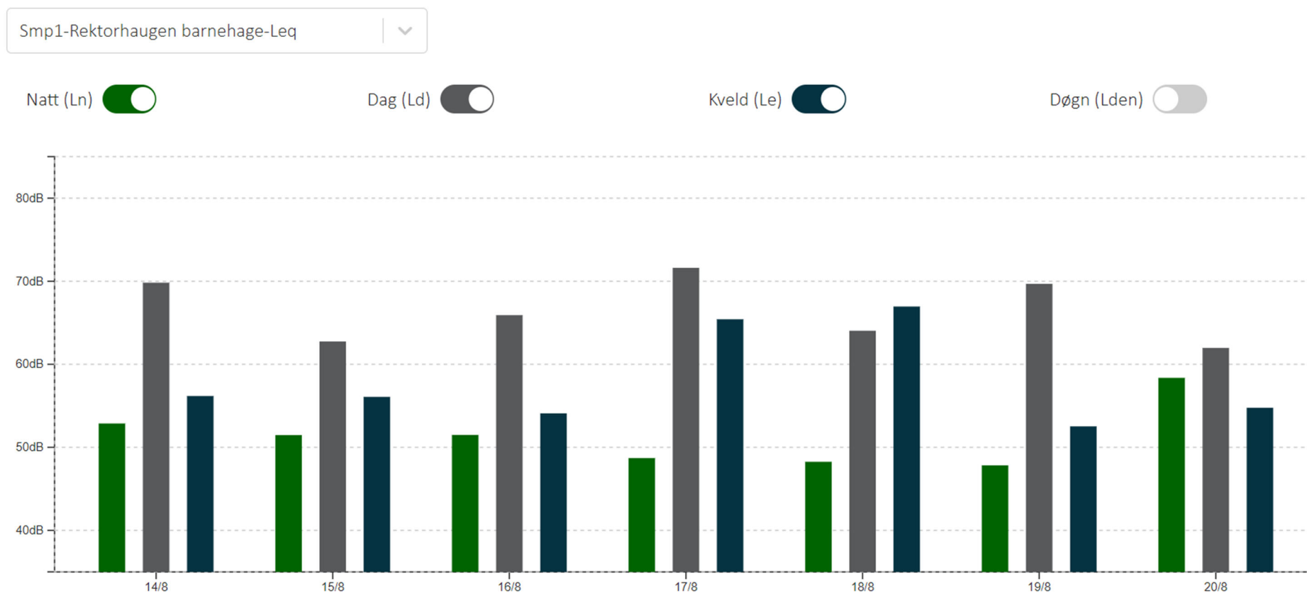
Figur 3 Resultater fra målestasjon Rektorhaugen barnehage over støyskjermen for perioden 14. august til og med 20. august. Stolpene viser gjennomsnittsverdier for dag (7-19), kveld (19-23) og natt (23-07).
