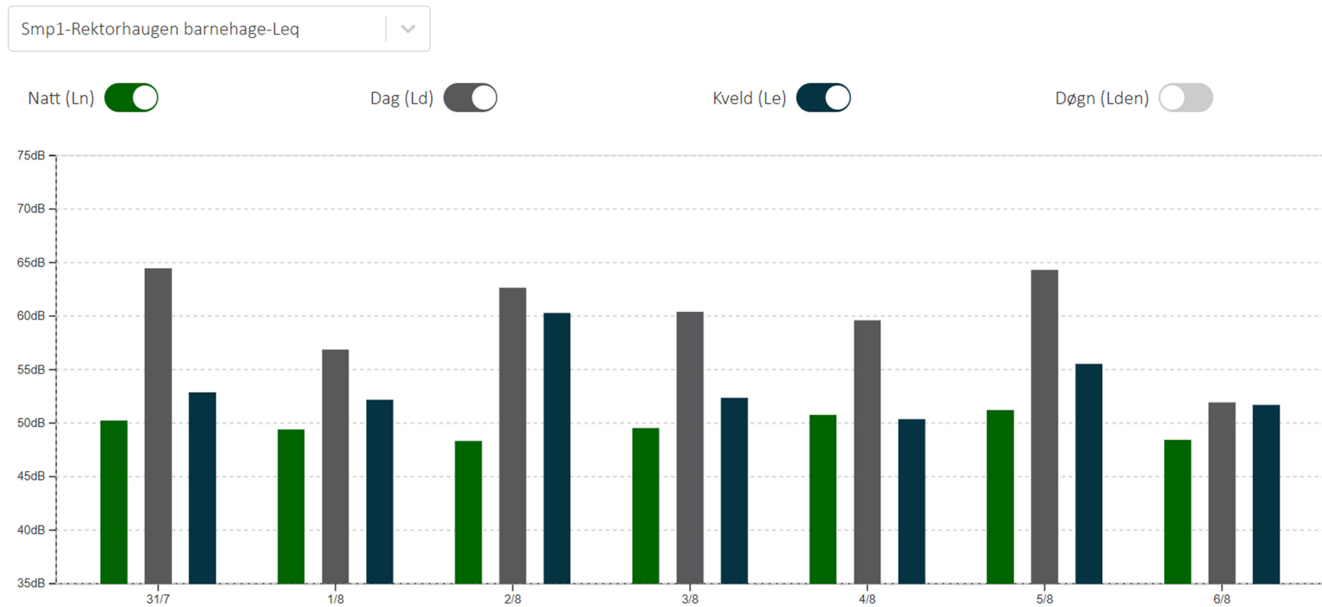
Figur 3 Resultater fra målestasjon Rektorhaugen barnehage over støyskjermen for perioden 31. juli til og med 6. august. Stolpene viser gjennomsnittsverdier for dag (7-19), kveld (19-23) og natt (23-07).
