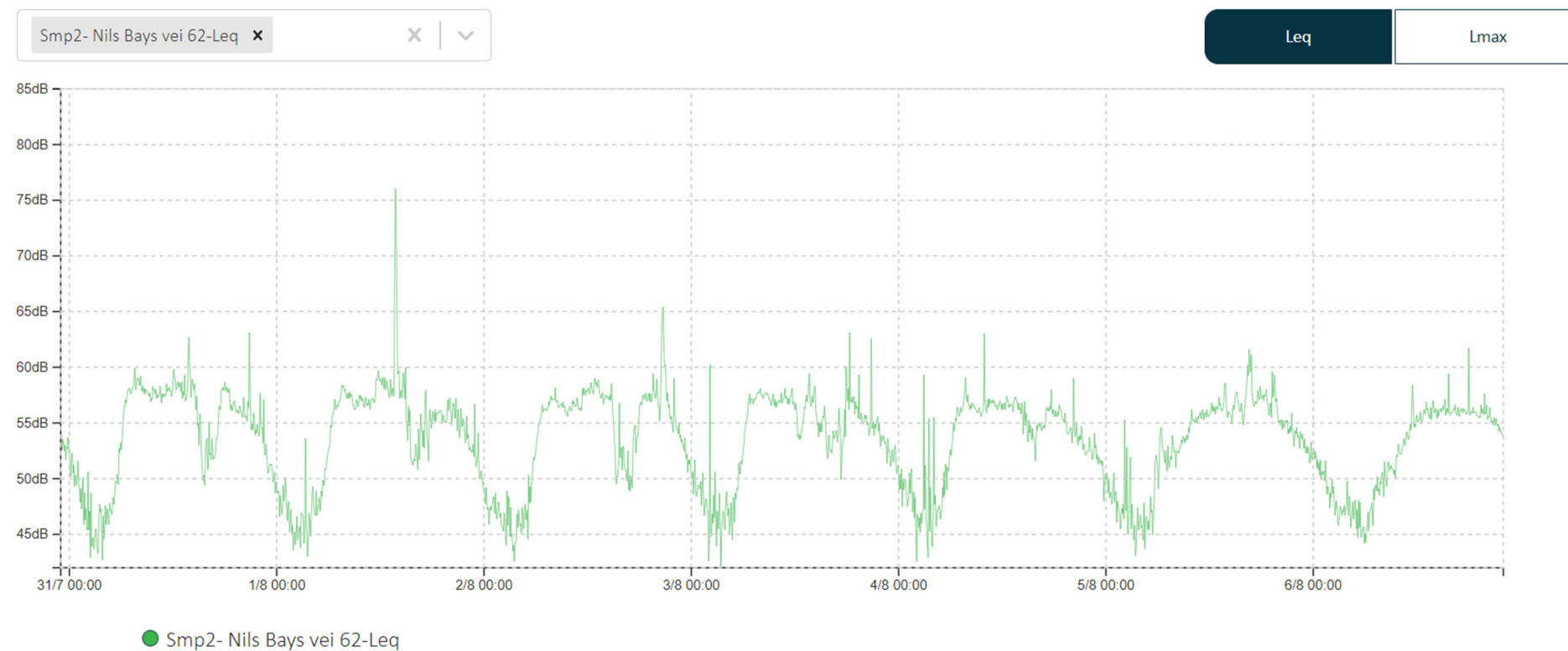
Figur 7 Støymålinger fra målestasjonen Nils Bays vei 62 for perioden 31. juli til og med 6. august. Kurven viser femminuttersverdier for støy gjennom hele måleperioden.
