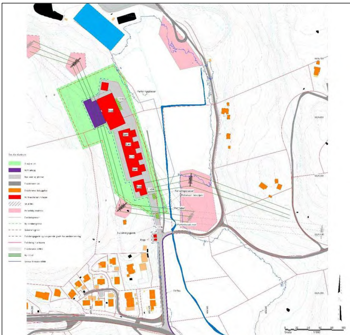
Figur 2-4. Situasjonsplan for Liåsen transformatorstasjon, alternativ B.
