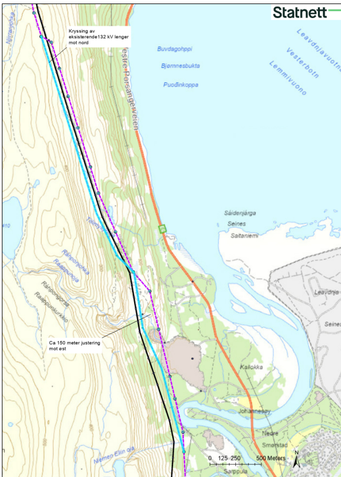
Figur 5: Kart som viser trasejustering ved Rahppa. Turkis strek viser konsesjonsgitt trase og lilla strek er den som nå er planlagt. Se også visualisering av traseén i Figur 4.
