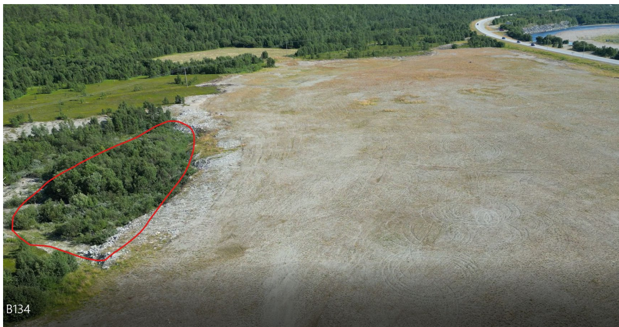
Figur 12. Bildet viser hvor overskuddsmasser er planlagt deponert på Repparfjordsletta. Området for deponi inngår reguleringsplan Rv94 Skaidi-Ariselv.
