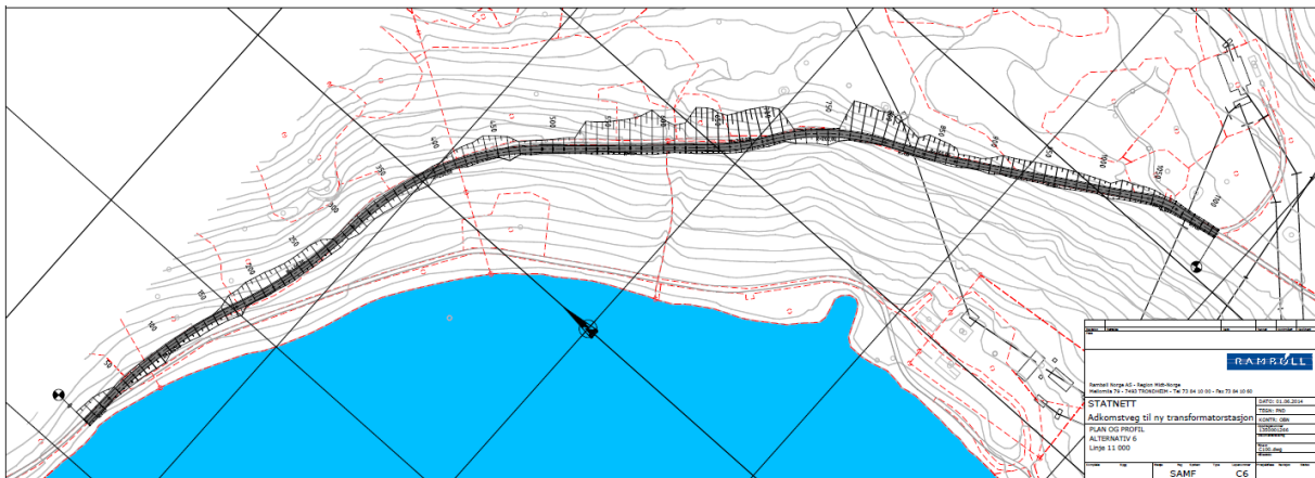
Figur 3: Figuren viser hvor det er behov for skjæringer i veien opp mot stasjonen.
