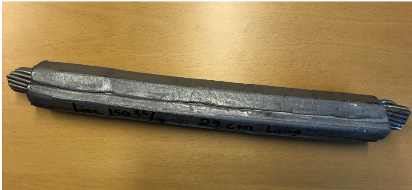
Figur 4.4-1 Håndpresset lineskjøt. 29 cm lang hylse. Linediameteren er 2,17 cm.
