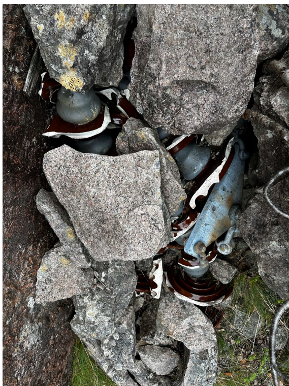
Figur 40 Funn av åk med fasefeste på Kanstadfjellet skjult under stein.
