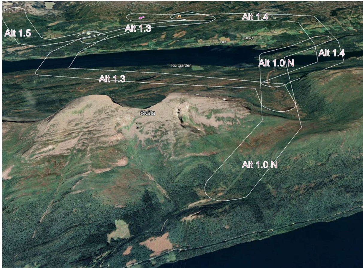
Figur 32: Ledningstraséene vist i terrenget. I forkant er hogstgaten fra dagens ledning synlig. Dagens trasé ligger inne i alt 1.0N, og synligheten av ny ledning vil bli noe tilsvarende, men med noe større master.
