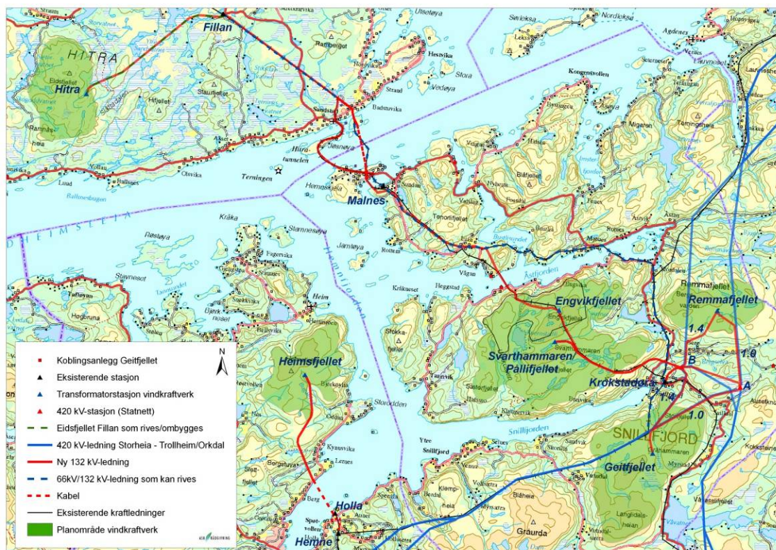
Figur 19. Planlagt 132 kV-nett fra vindkraftverkene og traseer for ny 420 kV-ledning fra Storheia på Fosen til Trollheim og eller Orkdal. De to alternative stasjonsplasseringene (A og B) for ny 420 kV stasjon i Snillfjord er vist med røde trekanter.
