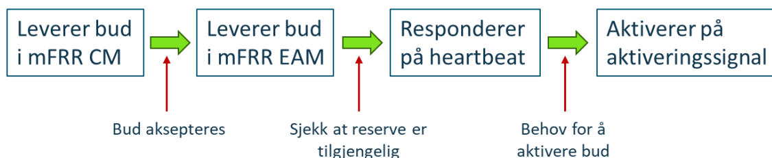
Figur 2 Stegene fra budgivning i kapasitetsmarkedet frem til aktivering i aktiveringsmarkedet som er relevante for avkortning.
