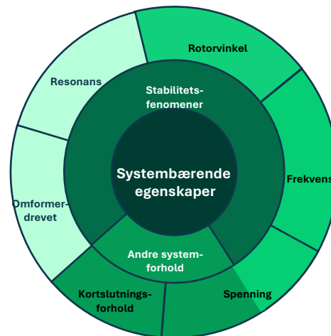
Figuren illustrer de sentrale systembærende egenskapene, som er grunnleggende forutsetninger for at kraftsystemet skal fungere. De henger sammen med hverandre og kan ikke ses på isolert (må ha en helhetlig tilnærming)
