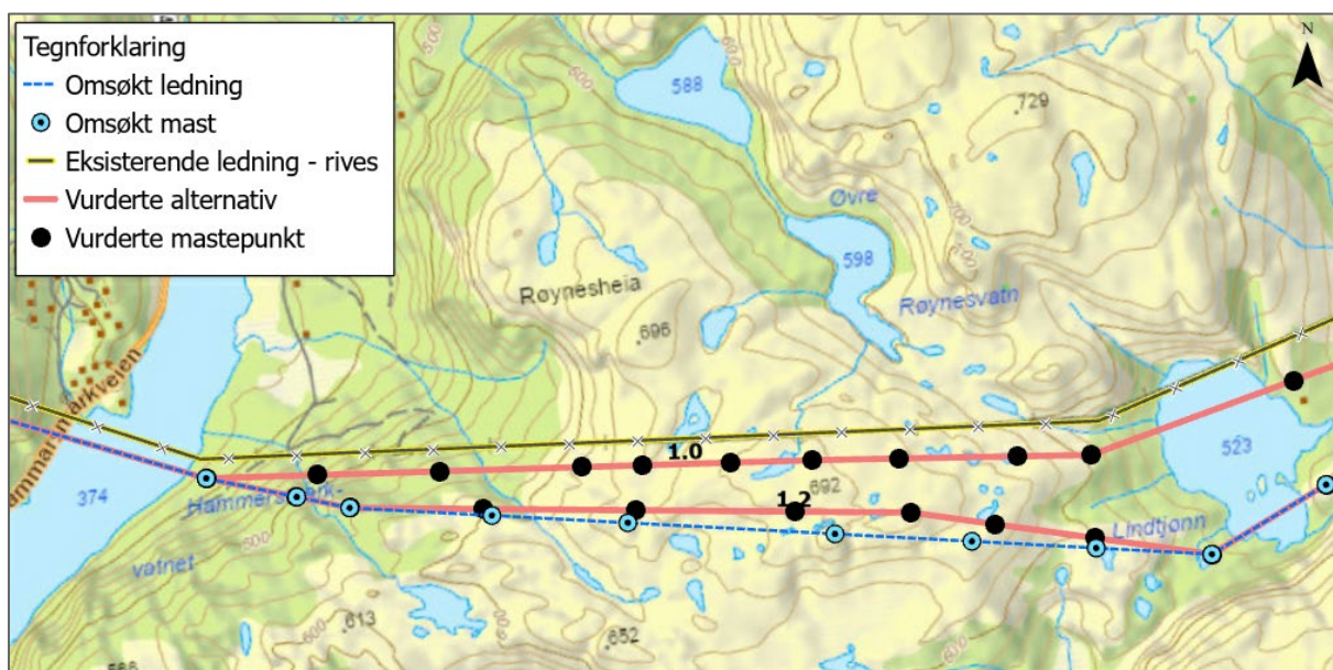
Figur 18 Statnett har rettet ut alternativ 1.2 og redusert to mastepunkt. Omsøkt ledning er illustrert med blåstiplet linje. Konsekvensutredet alternativ illustrert med røde linjer.
