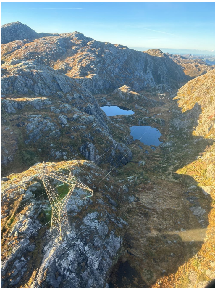
Figur 18 Statnett har justert trasé for ny 420 kV forbindelse til å følge eksisterende 300 kV lavere i terrenget enn tidligere vurdert løsning i høyden.
