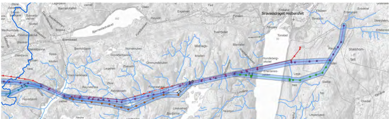
Figur 7-6: Kart over delområde VM6 Siravassdraget. Alt. 1.0 inkl. 100 m buffersone er vist med lilla linje. Berørte vannforekomster er vist med blå streker. Variant 1.1 er grønn, Variant 1.2 er oransje, og Variant 1.3 er blågrønn. Eksisterende linje som skal rives, er rød.
