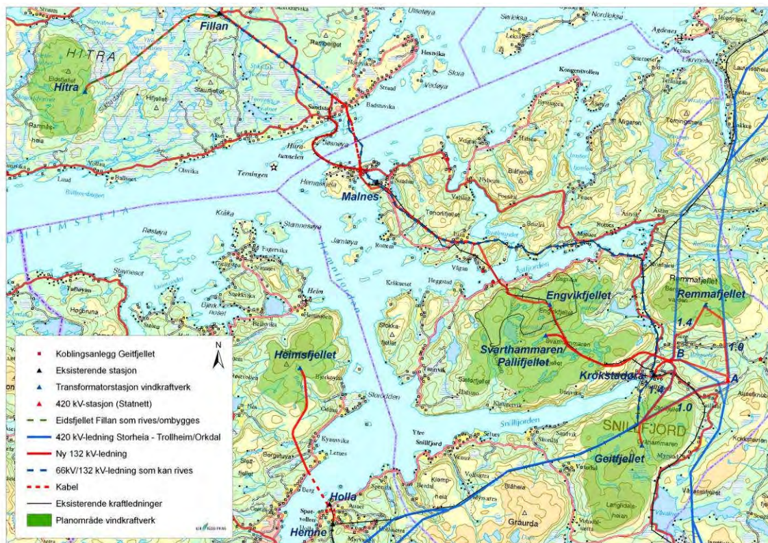
Figur 18. Planlagt 132 kV-nett fra vindkraftverkene og traseer for ny 420 kV-ledning fra Storheia på Fosen til Trollheim og eller Orkdal. De to alternative stasjons plasseringene (A og B) for ny 420 kV stasjon i Snillfjord er vist med røde trekkanter.
