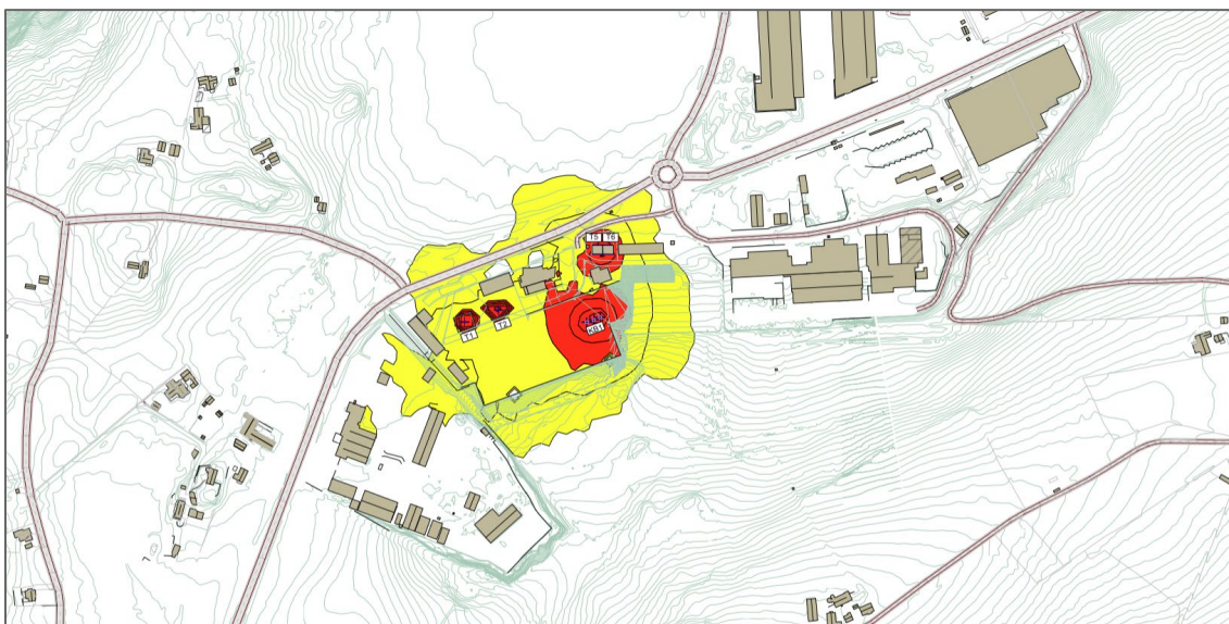
Figur 29 Støyberegninger for omsøkte Humleberget transformatorstasjon. Gul farge indikerer støy høyere enn 50 dB. Rød farge indikerer støy høyere enn 60 dB.
