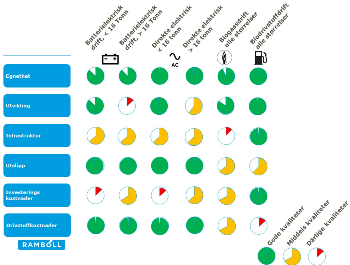
Figur 2: Oversikten viser ulike typer energibærere for fossilfri anleggsvirksomhet av maskiner, der mye fyll i kakene angir kvaliteten til ulike egenskaper som er listet opp på venstre side.
