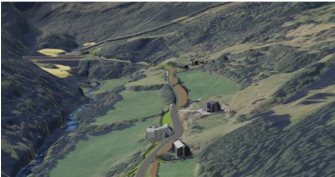
Figur 14 Illustrasjon av arealbeslag for breddeutvidelsen av adkomstvei inn til ny transformatorstasjon. Tre masselager i området rundt transformatorstasjonen vises i bildets bakkant. Kilde: Sweco 2024.
