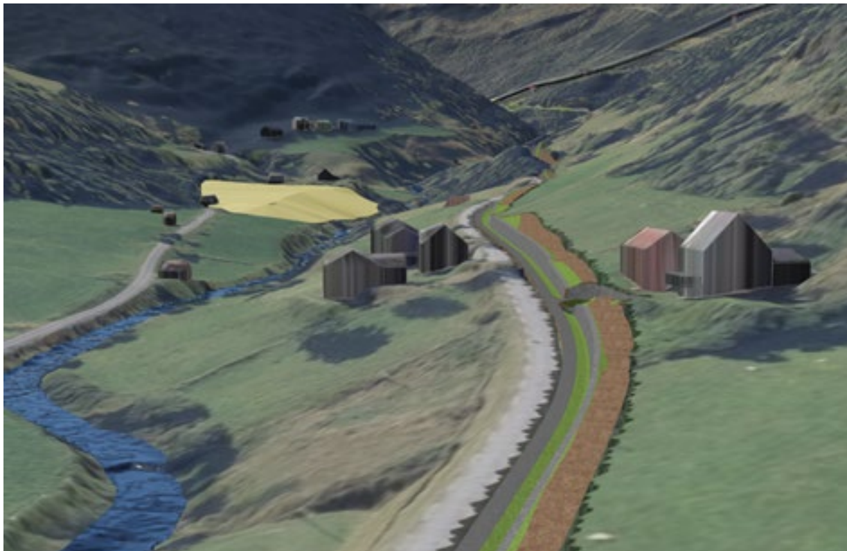
Figur 9 Bilde fra modell fra Ovrítsdalen, som viser oppgradert veg med natursteinsmurer, fylling og skjæring.
