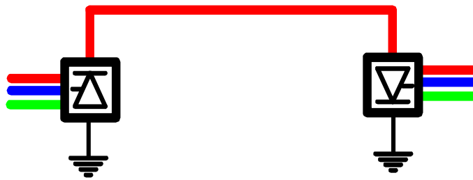
Figur 3 Monopol med elektrodeanlegg
