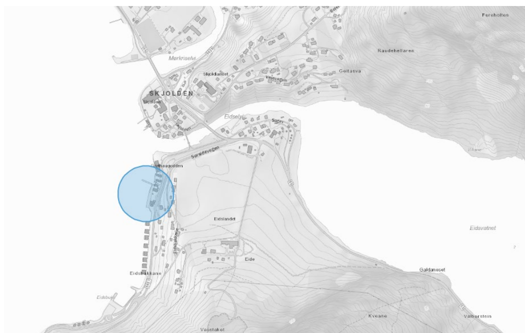
Figur 3 Område som krever utbedringer langs veien for å få transportert transformatorer. Sirkel på nederste kart viser kai for ilandføring av transformator.
