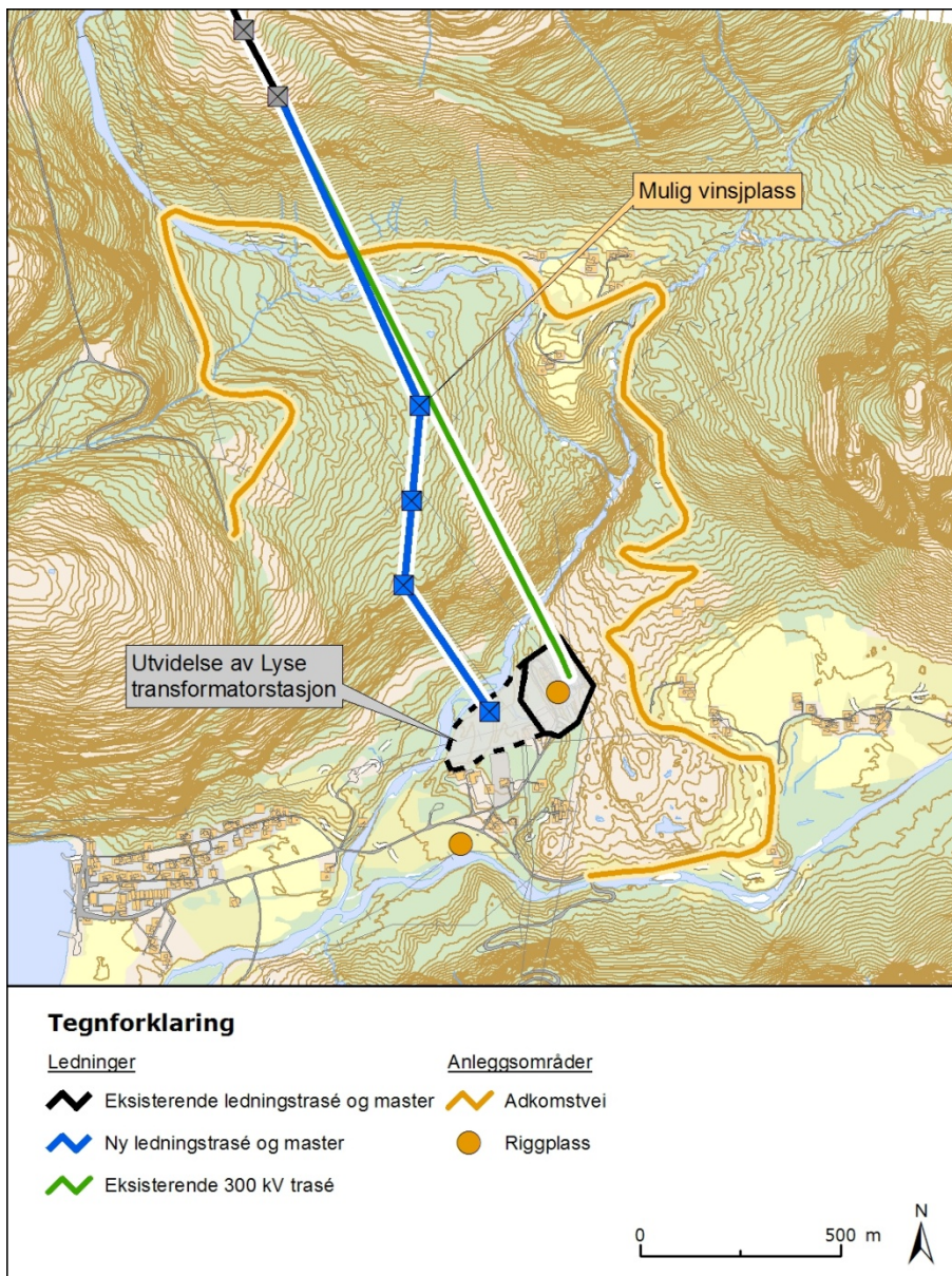
Figur 17. Transportveier og riggområder for omlegging ut fra Lyse transformatorstasjon
