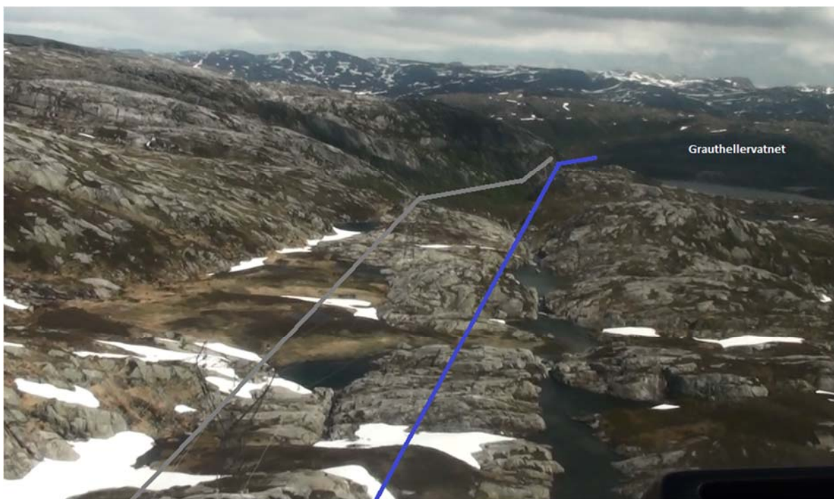
Figur 16. Omsøkt trasé med blå strek i retning østover mot Grauthellervatnet. Eksisterende ledning ligger til venstre for traseen, vist med grå strek.
