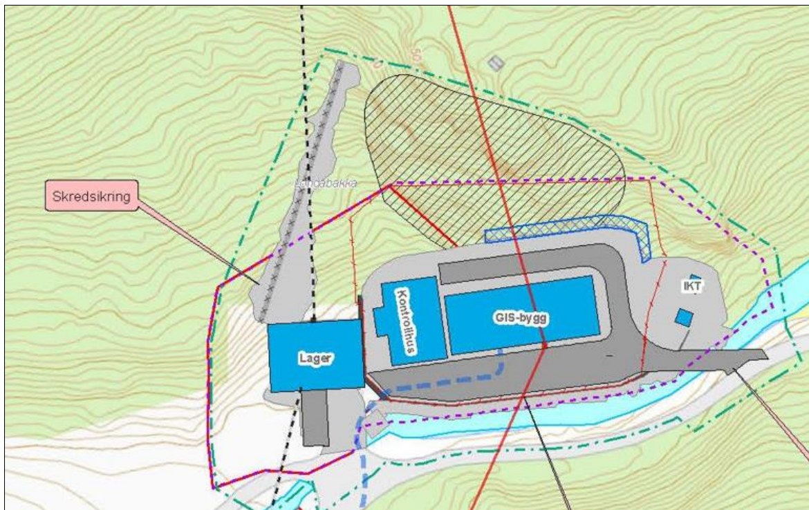
Figur 7. Omtrentlig areal for rensk og sikring av løst fjell ved Hylene koblingsstasjon (skrå skravur). Fremtidig eiendomsgrense er vist med lilla stiplet linje. Illustrasjonen er et utsnitt fra MTA-planen.
