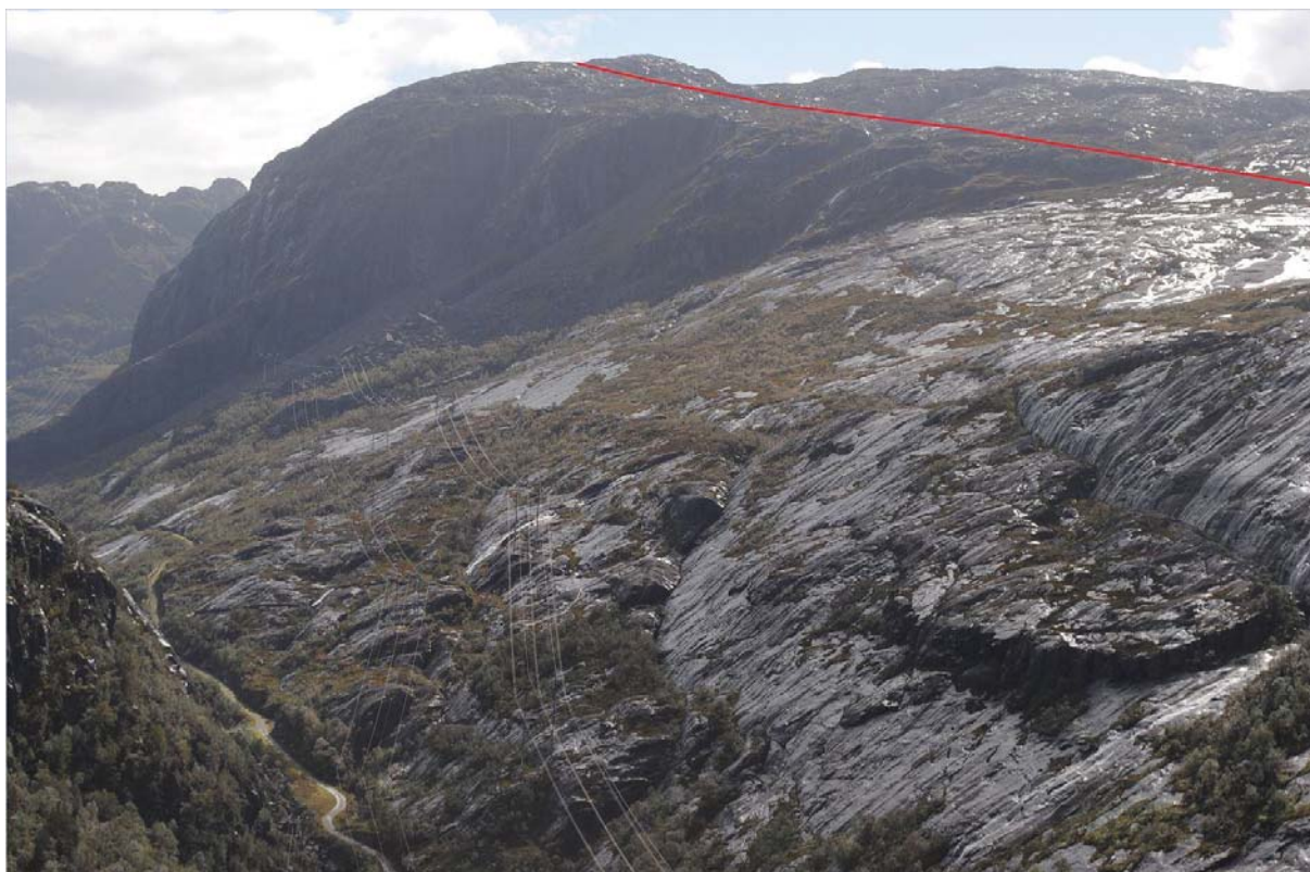
Figur 14. Stølsdalen sett mot sør. Førre transformatorstasjon er bak fotografen. Skredfare og topografi gjør at traséen til planlagt 420 kV-ledning er lagt høyere i terrenget (rød strek).
