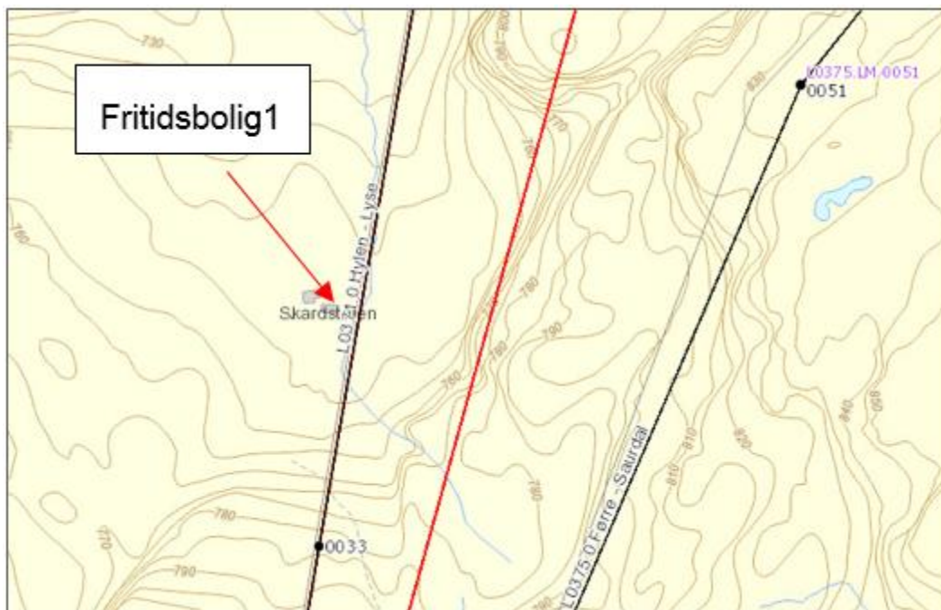
Figur 34. Fritidsbolig ved Skardsstølen. Rød strek viser 420 kV-ledning Sauda-Lyse, mens sorte streker viser eksisterende ledninger.
