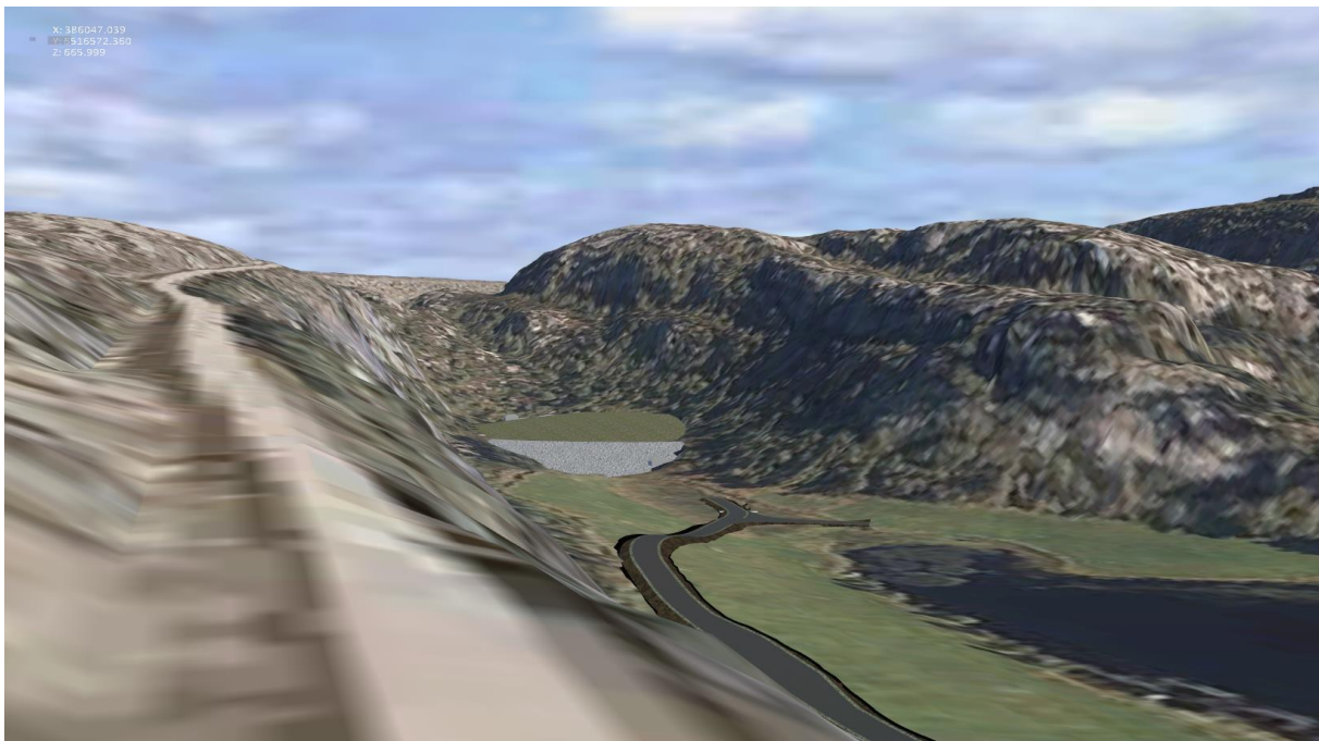
3 B. 3D –modell av prosjektert deponi (12 200 m 3 ), sett fra sørvest langs vei til Nesjen. Voll i framkant av deponi skal tildekkkes med jord og revegeteres.
