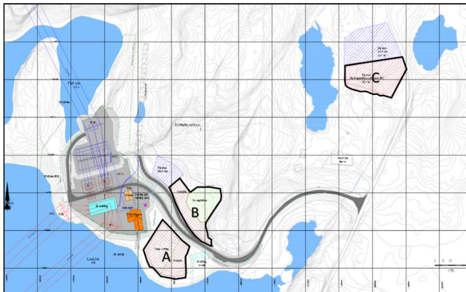
Figur 3 Plassering av ulike riggområder ved Fjotland transformatorstasjon.
