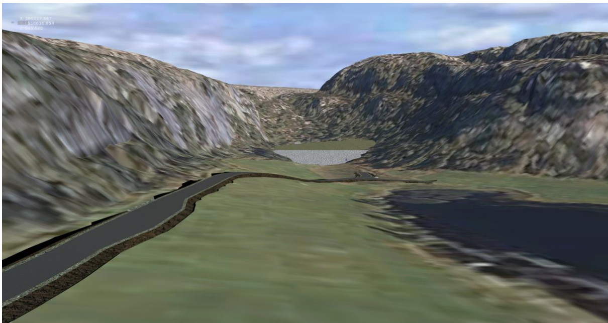
3 B. 3D-modell av prosjektert deponi (12 200 m 3 ), sett fra sør. Voll i framkant av deponi skal tildekkes med jord og revegeteres.
