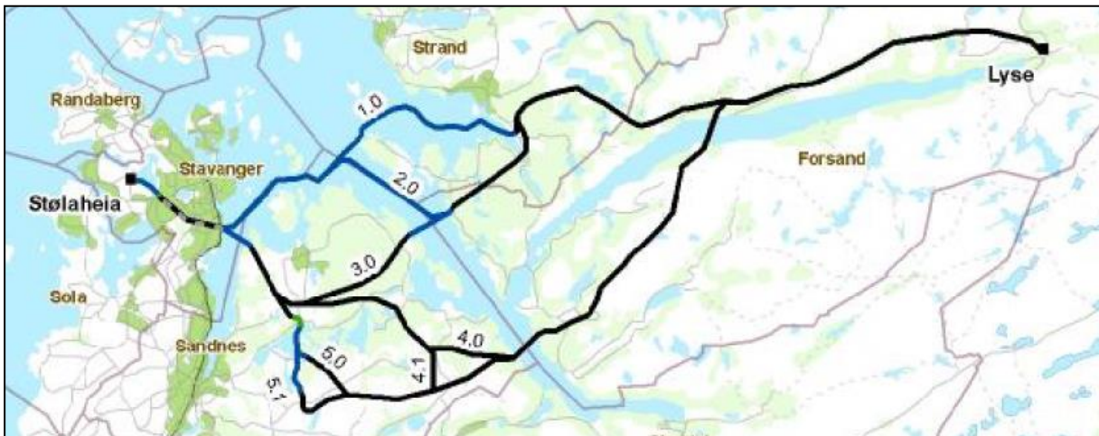
Figur 7 Traseer som ble foreslått utredet i 2012. Svarte streker er luftledning, blå streker er sjøkabel og stiplede strek er kabel i tunnel. (Kilde: Ny sentralnettforbindelse til Sør-Rogaland - En oversikt over behov, aktuelle løsninger og tema som planlegges konsekvensutredet, Lyse Sentralnett 2012)
