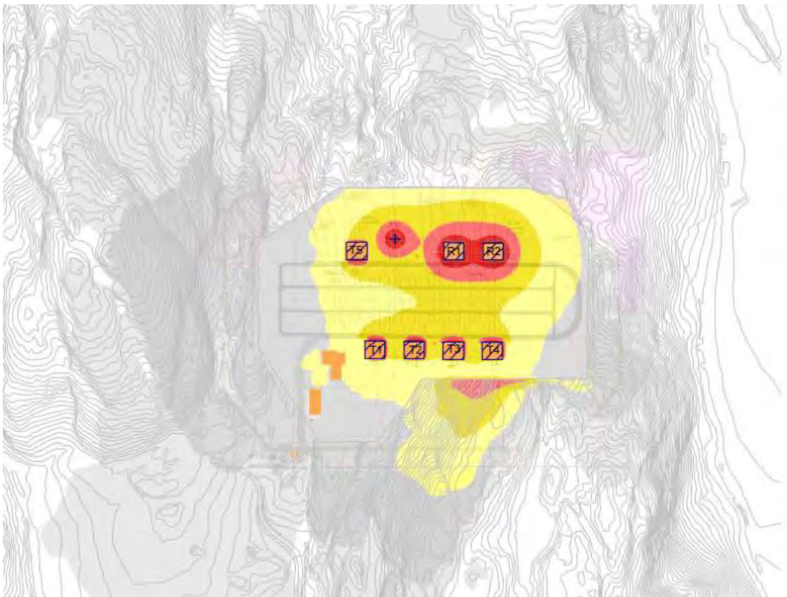
Figur 32 Støykart trinn 1. Gul og rød sone er støy over Lden 50 dB. Grå sone er støy over Lden 40 dB.
