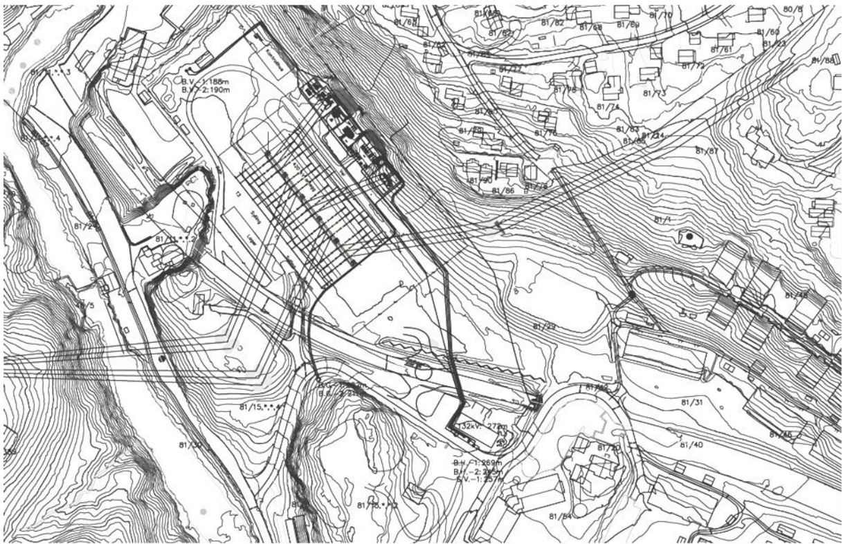
Figur 5: Situasjonsplan for fremtidig anlegg ved ombygging til konvensjonelt utendørs 420 kV anlegg (alt. 1) (kilde: Statnett)
