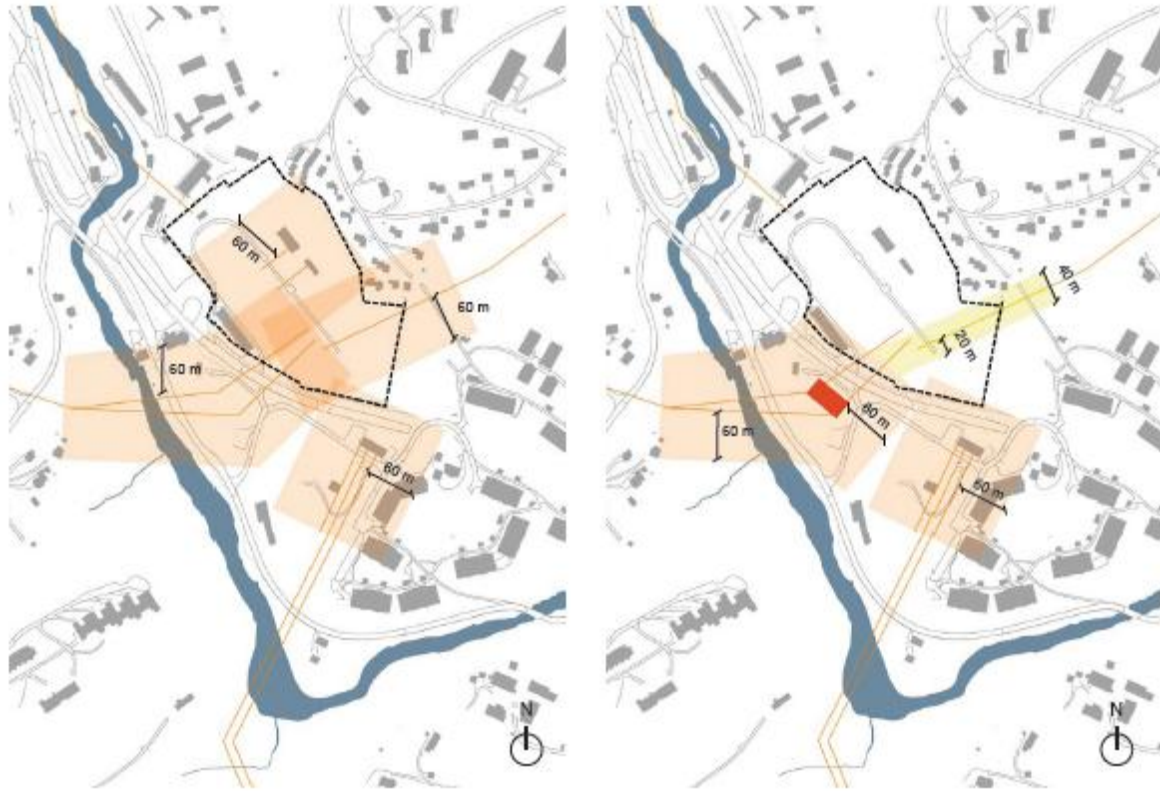
Figur12, skissene viser typiske feltområder der en kan forvente verdier større enn 0,4 \mu\text{T} . Skissen til venstre viser friluftsanlegg mens skissen til høyre viser SF6-anlegg samt eventuell kabel på den første delen av Bærumlinja. I utgangspunktet vil en beholde linje mot Bærum og da vil det fortsatt være et 60-70 meters belte, til hver side, langs denne. 47 kV linjene, som ligger nærmest mot Hamanggården, vil fortsatt ha samme trase uansett alternativ 1 eller 2. Disse er eid av Hafslund.
