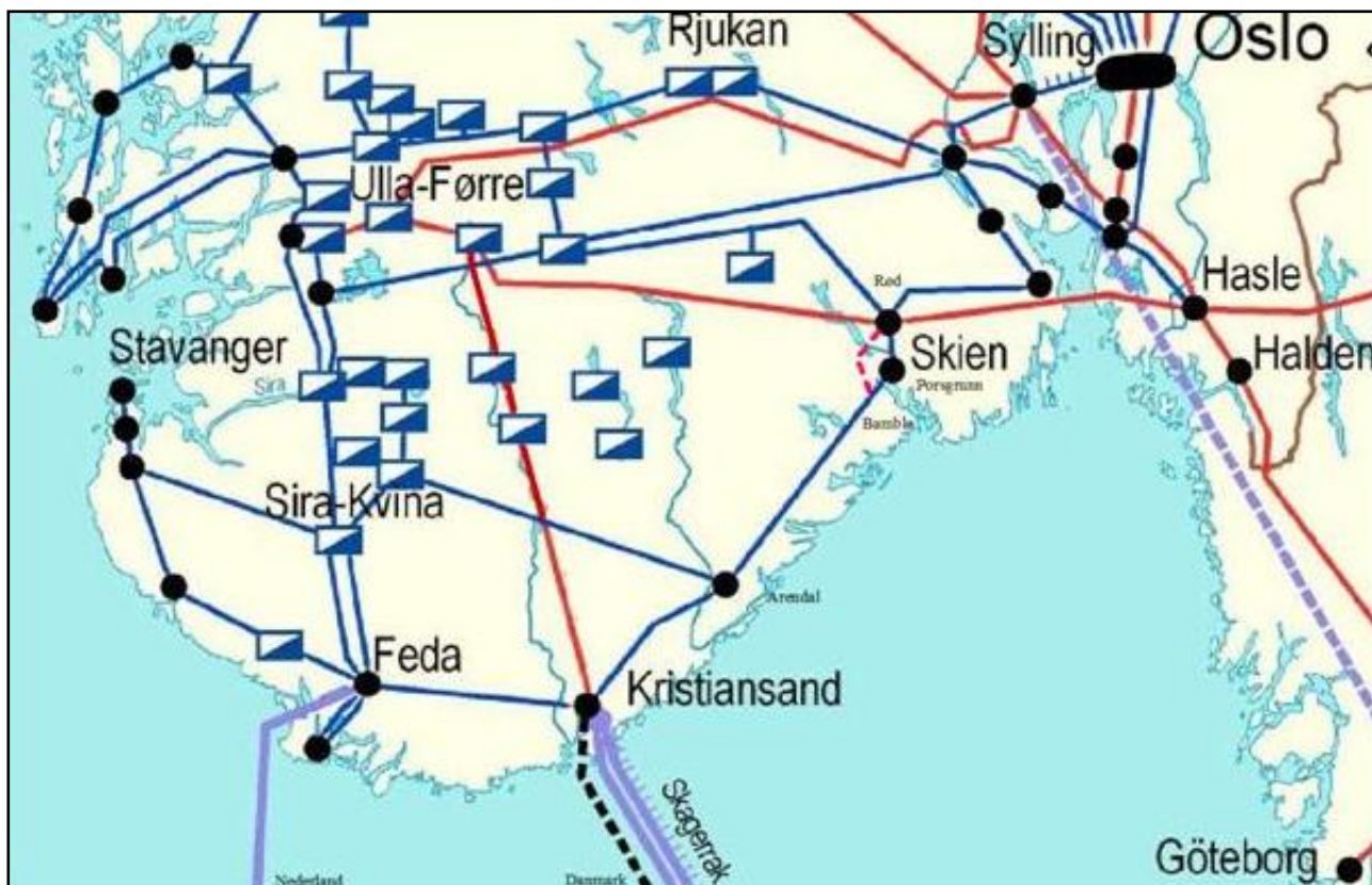
Figur 2. Kraftsystemet på Sørlandet. Røde streker markerer 420 kV-ledninger. Blå streker markerer 300 kV-ledninger. Blå strek fra Kristiansand via Arendal til Bamble viser den omsøkte strekningen for spenningsoppgradering. Videreføringen til Rød transformatorstasjon, meldt 420 kV-ledning Bamble-Rød, er vist med stiptet rød strek vest for Skien. Firkanter markerer kraftverk og svarte punkter markerer transformatorstasjoner.
