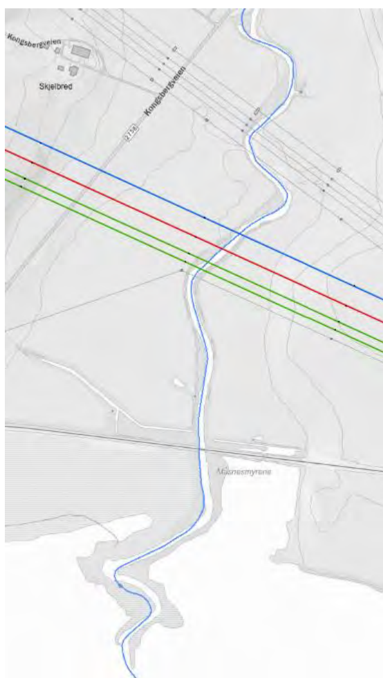
Figur 4-72 Grått ledningsnett i kartunderlaget viser eksisterende ledningsnett der deler skal saneres. Blå piler viser enkeltmaster som skal saneres i nedbørfeltet til øvre Dørja.
