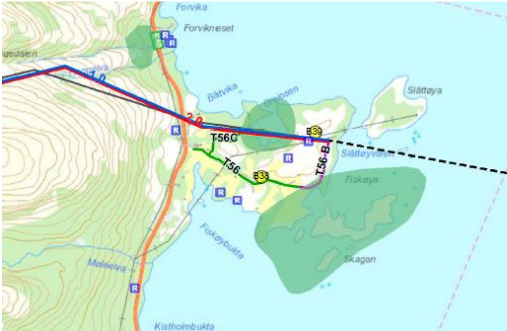
Figur 6: Traseen (rød og blå strek) må justeres noe ved ei vinkelmast ved Heggdalen sammenliknet med dagens trasé (svart strek).
