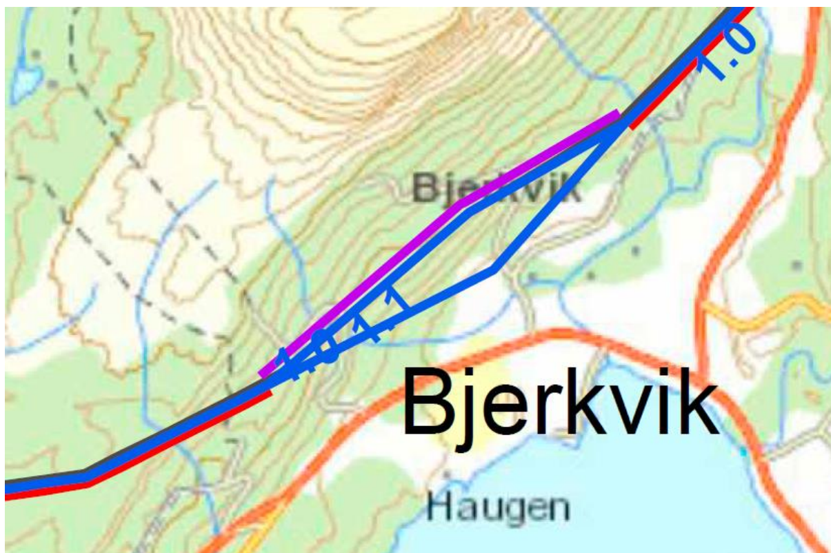
Figur 11: Kvitnesledningen legges om til ny trasé nord for dagens trasé (lilla strek) og ny ledning parallellføres med denne (øvre blå strek, alternativ 1.1). Sekundært søkes det om at ny ledning følger dagens trasé (nedre blå strek, alternativ 1.0).
