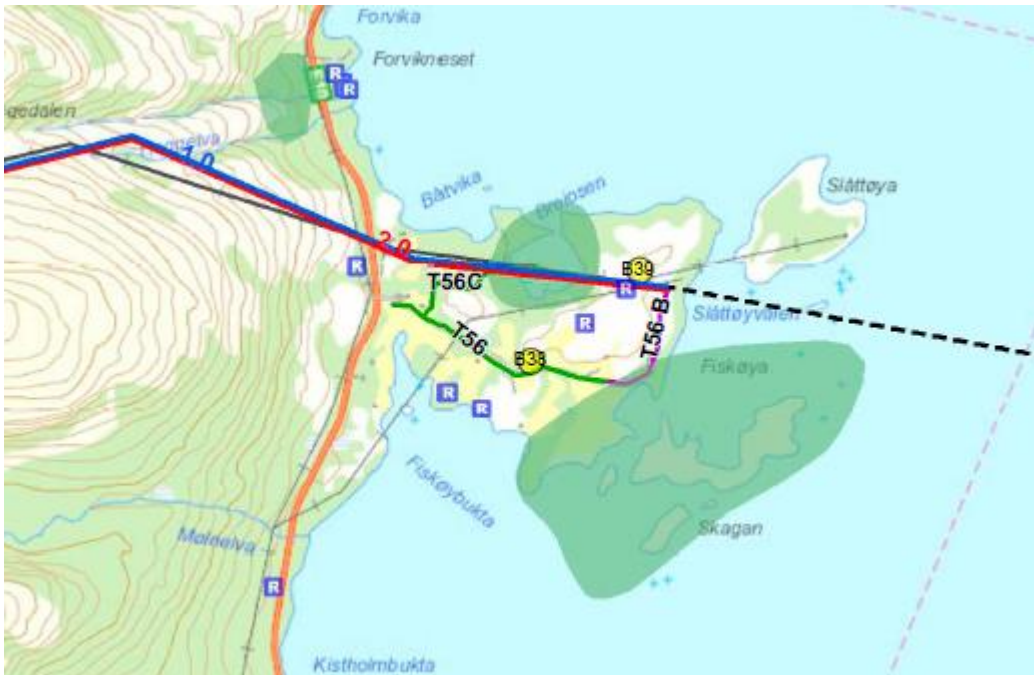
Figur 15: Traseen (rød og blå strek) må justeres noe ved ei vinkelmast ved Heggdalen sammenliknet med dagens trasé (svart strek).
