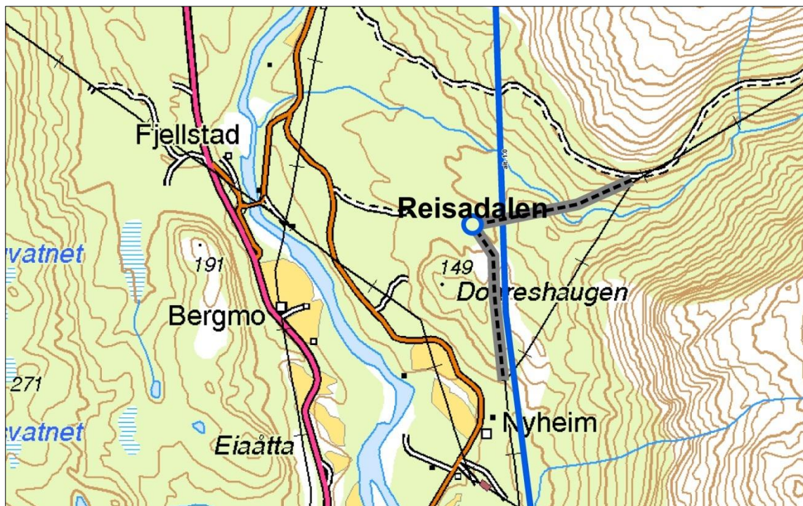
Figur 17. Omlegging av eksisterende 132 kV-ledning ved Doareshaugen i Nordreisa kommune. Blå strek viser omsøkt trasé for 420 kV-ledningen. Grå strek viser aktuell strekning for omlegging.
