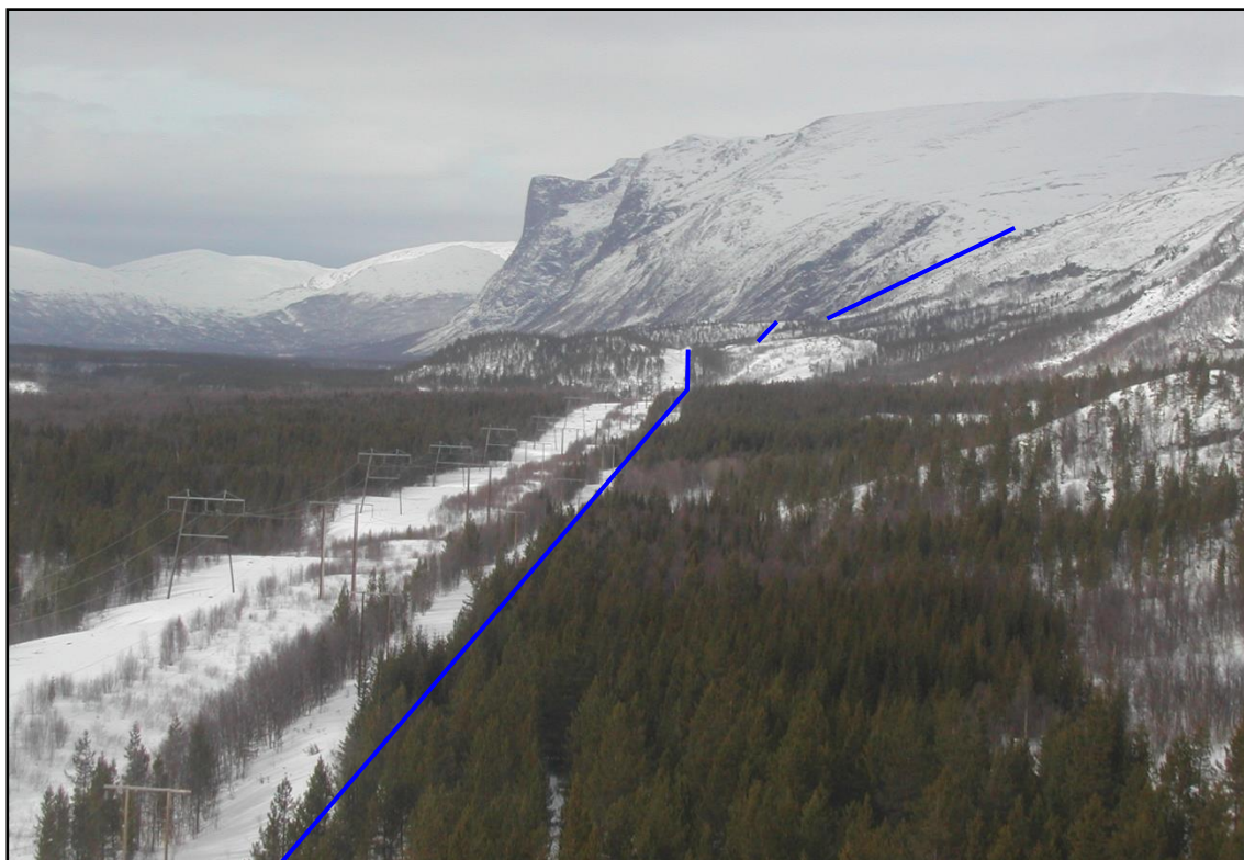
Figur 11. Reisdalen med eksisterende ledninger (sett fra sør). Blå strek viser traséen til omsøkt 420 kV-ledning.
