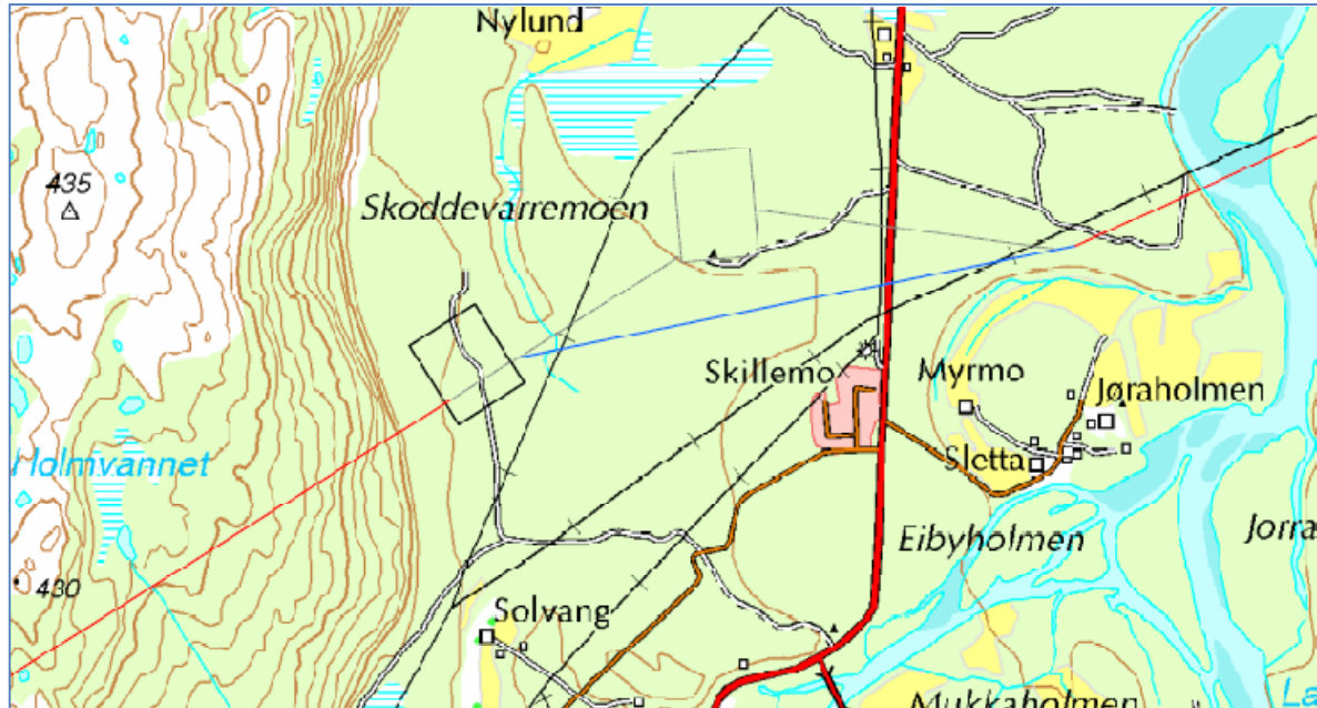
Figur 6. Endret transformatorplassering i Alta ved Skoddevarre vist med sort firkant. Blå linje viser ny trasé ut fra denne. Tidligere plassering finnes oppe til høyre for ny trafoplassering.
