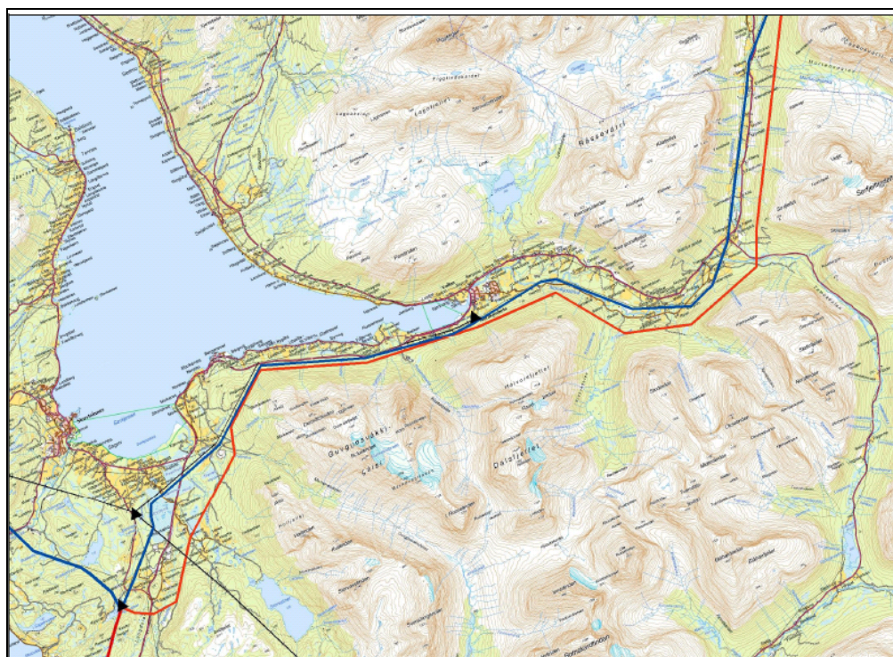
Figur 5.1. Traséalternativ 1.0 for planlagt 420 kV-ledning i Balsfjord er vist med rød strek. Eksisterende 132 kV-ledninger er vist med blå strek og eksisterende 66 kV-ledningen med sort strek. Sorte trekanter er eksisterende stasjoner.
