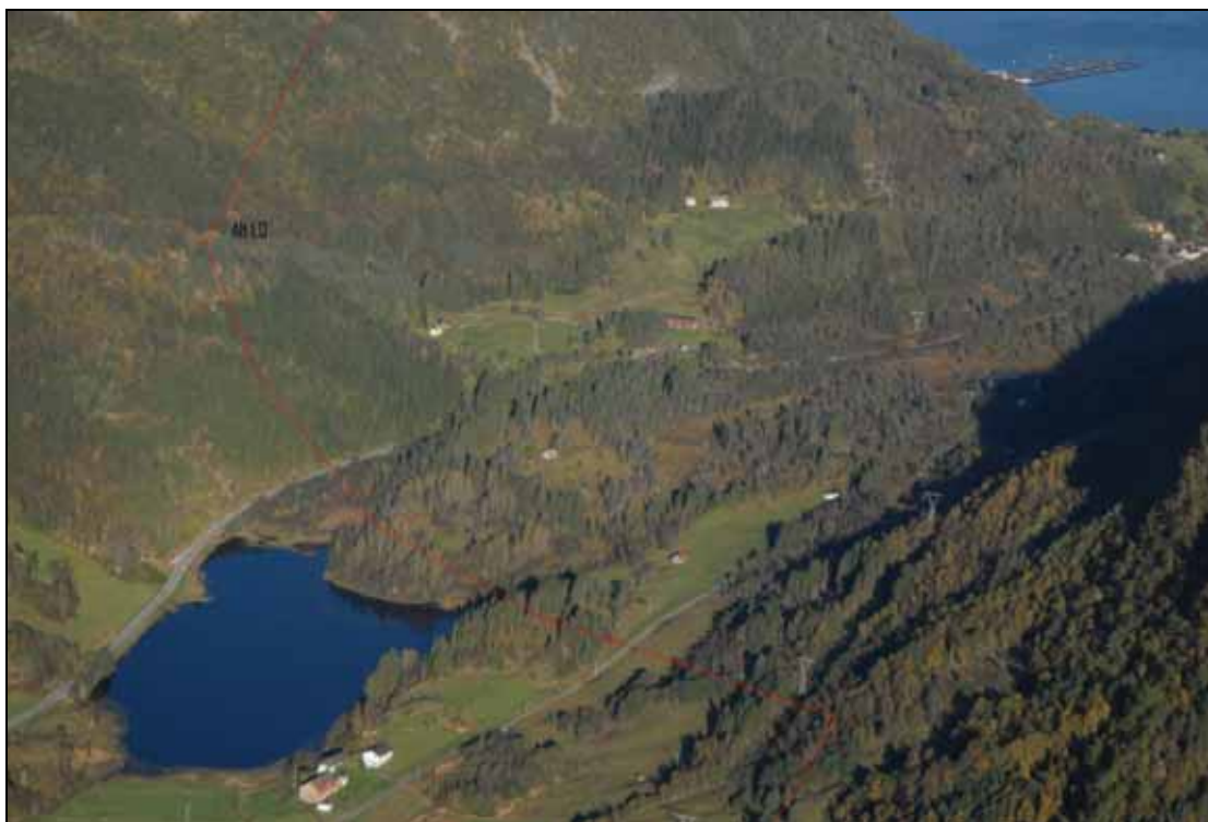
Figur 7: Almeskard/Søvik i Sykkylven. Med rød strek er lagt inn traséalernativ 1.0 der det krysser over dagens 132 kV-ledning. Dette gjøres for å komme lengre bort fra bebyggelsen mellom Litlsevatnet og Søvik og komme høyere i lia frem mot fjordspennet over Storfjorden mellom Vindsneset og Gausneset.
