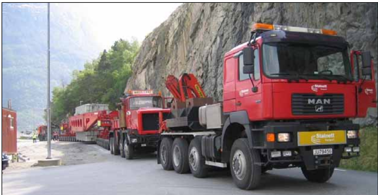
Figur 94: Transformatortransport stiller strenge krav til stigning, svingradius, bæreevne på veilegene osv.
