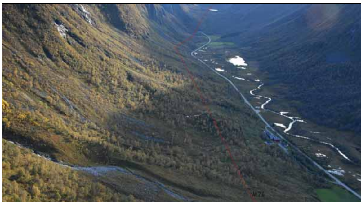
Figur 25: Strandadalen. Omsøkt trasé ved Røyr sett mot sør. Traséen er her lagt på østsiden av dalen pga stor skredfare på vestsiden, men det går skred på begge sider av dalen.
