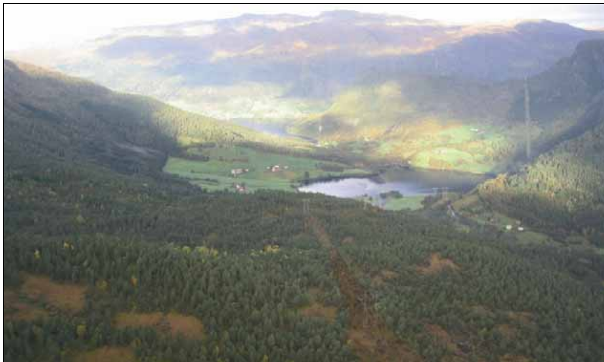
Figur 54: Eldalsdalen. Fotomontasjen viser alternativ 1.0 ved passering av Fylingsvatnet. Dagens 132 kV ledning krysser over Fylingsvatnet mot gården Bell oppe til høyre. Ny 420 kV-ledning krysser dagens 132 kV-ledning på denne siden av vatnet og fraviker parallellføringen et stykke for å komme lengre bort fra bebyggelsen ved vatnet og på Bell. Hogstgaten for ny ledning er vist opp lia øst for Bell. Illustrasjon: Agraff AS.
