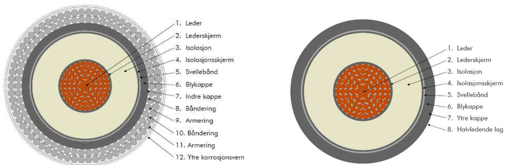
Figur 3-1 PEX isolert vekselstrømskabel, henholdsvis sjø- og jordkabel (kilde Nexans)
