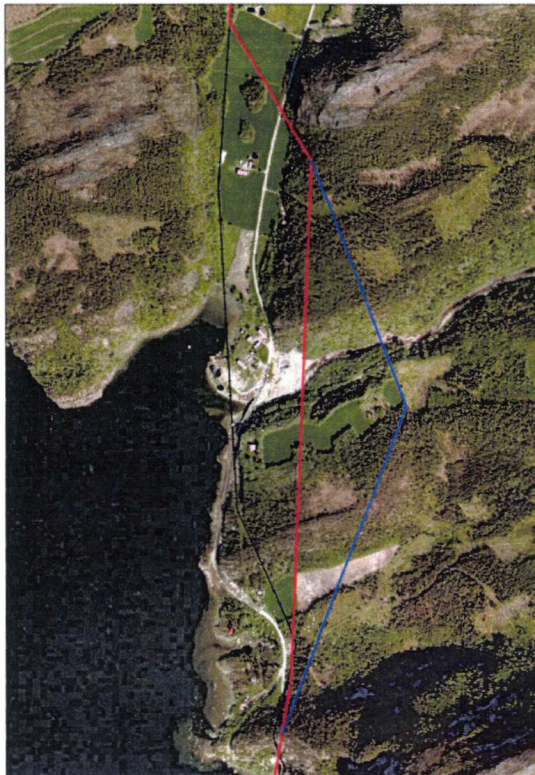
Figur 3: Flyfoto som viser konsesjonsgitt trasé for 132 kV (rød strek) og foreslått justert trasé (blå strek) ved Arnvika i Åfjord. Den svarte streken er eksisterende 66 kV kraftledning som skal rives ved bygging av den nye kraftledningen. Kilde: ASK notat 13.09.10.
