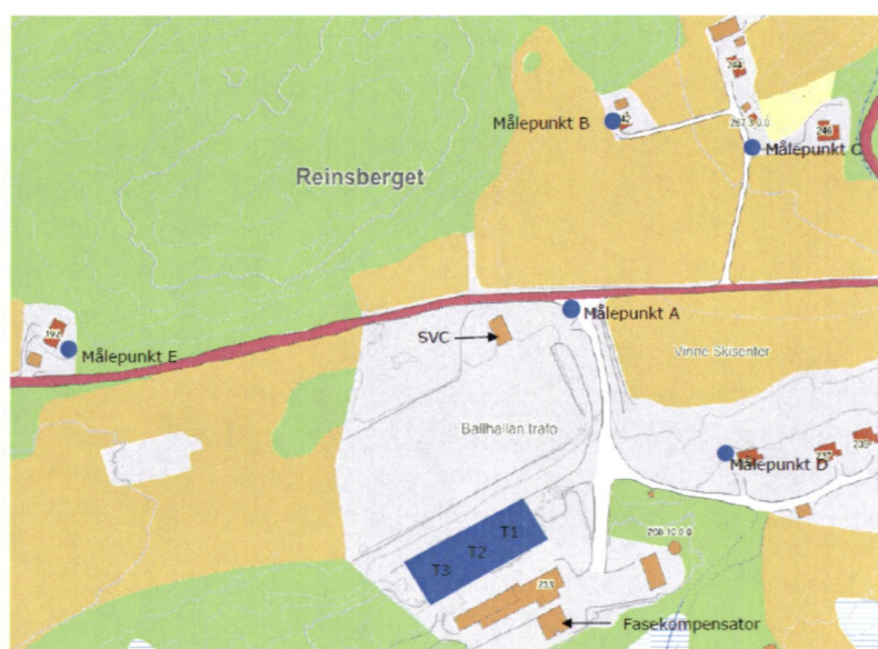
Figur 11: Kartet viser anleggene ved Verdal transformatorstasjon, bebyggelsen rundt stasjonen og de ulike punktene der støy ble målt. Kartet er fra Rambølls notat "Målinger av støy fra Verdal transformatorstasjon".
