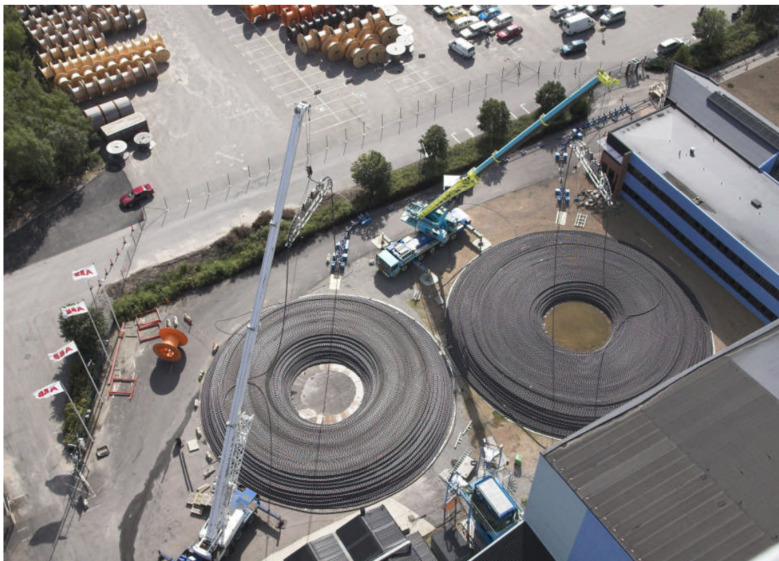
Figur 6-2. Bildet viser oppkveiling av kablen på fabrikk.
