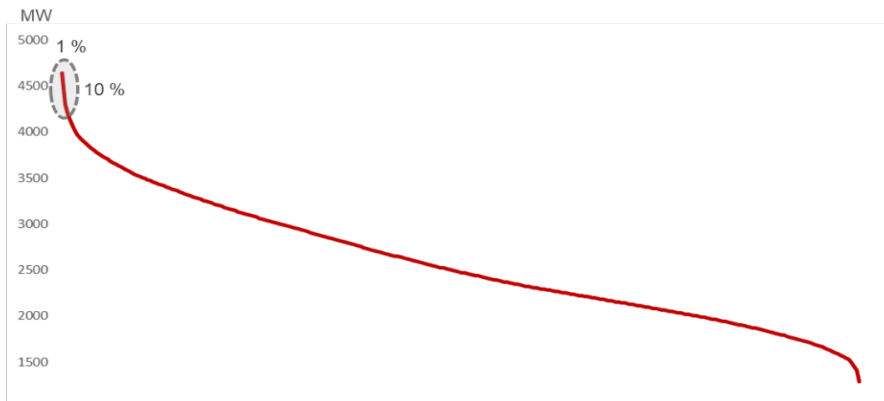
Figur 3: Varighetskurve som viser forbruket i Oslo og Akershus de siste årene, sortert fra høyeste til laveste verdi. Figuren viser at de 10 % høyeste verdiene av forbruket skjer i bare 1 % av tiden, og at det derfor er svært sjeldent det vil være behov for en nettkapasitet som forsyner hele forbruket. De samme egenskapene ser vi i områder med stort produksjonsoverskudd.
