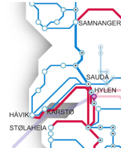
Figur 25: SKL-ringen med ny ledning fra Vestre korridor. Tykke streker markerer duplex/triplex. Røde streker markerer 420 kV drift.
