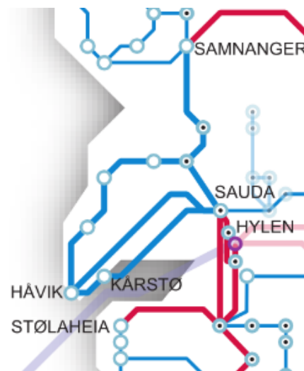
Figur 22: SKL-ringen rundt 2020 med oppgraderingskonseptet. Tykke streker markerer duplex/triplex. Røde streker markerer 420 kV drift.
