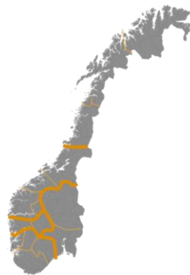
Figur 1-2: Samnett-modellen er i denne analysen simulert med 16 delområder i Norge (se vedlegg C). Tilnærming til dagens prisområde-inndeling markert med tykke linjer.
