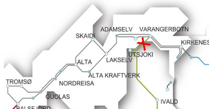
Figur 45 Når vi bryter ringdriften er Øst-Finnmark ensidig forsynt, og i en N-0-situasjon. Konsekvensne av utfall i en N-0-situasjon er avhengig av om området er i under- eller overskudd, og om området tåler overgangen til øydrift.
