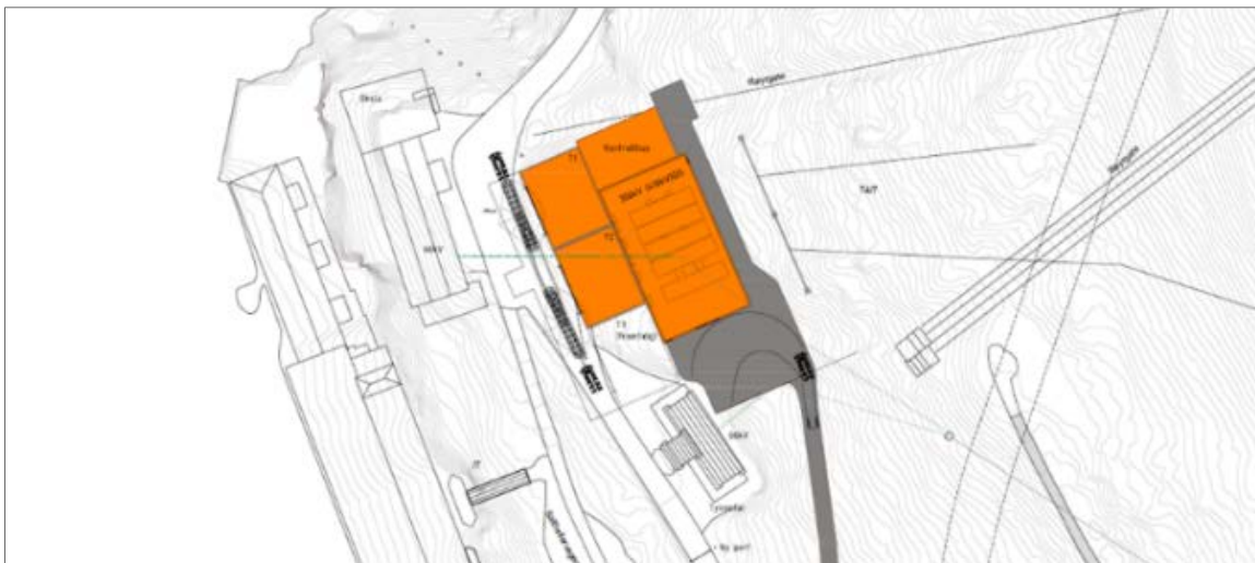
Figur 10: Skisse som viser nytt GIS-anlegg med adkomstveg ved Oksla kraftverk i Tyssedal
